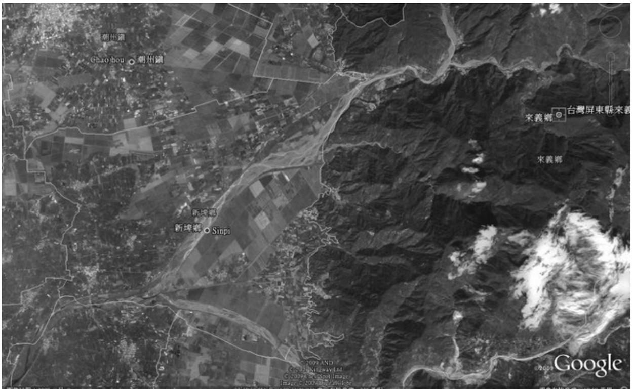
河堤將洪水集中、並於短時間內往下游匯灌，從古樓到出海口約只有20公里。如能在上游恢復洪泛區，則可以將大量的洪水停滯在廣大的空間，藉礫石地質快速入滲地下，是解決水患的根本之道。（資料來源Google）
