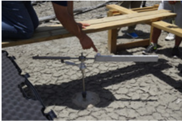
設置於 Jobos Bay National Estuarine Research Reserve 內變動最劇烈，最為敏感之穿越線上的 SET 裝置，用以監測氣候變遷海平面上升及淹水對於該保留區之影響。
